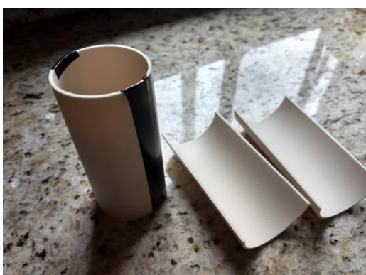
Figura 8 - Molde para corpo de prova cilíndrico de tamanho 50 mm por 100 mm
