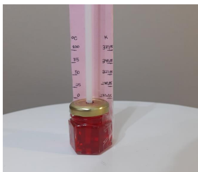
Figura 16 – Marcação da temperatura
