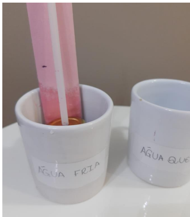
Figura 15 – Calibração do termômetro na água fria
