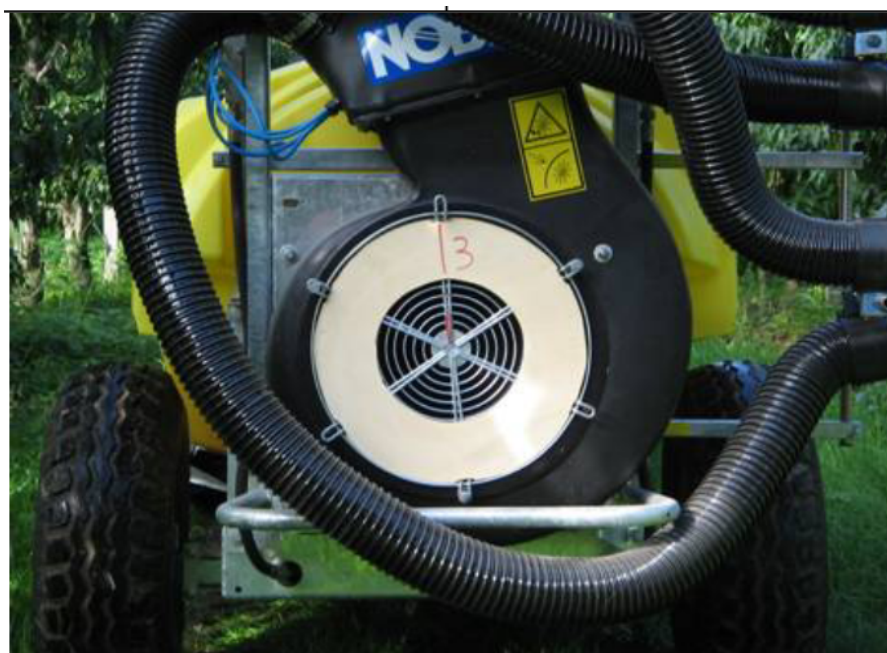
Figura 1- Redutor de ar em turbina axial.
