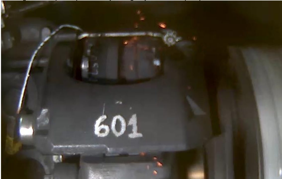
Figura 10 - Aparato para avaliação da geração de faísca pelo procedimento FMVSS.
