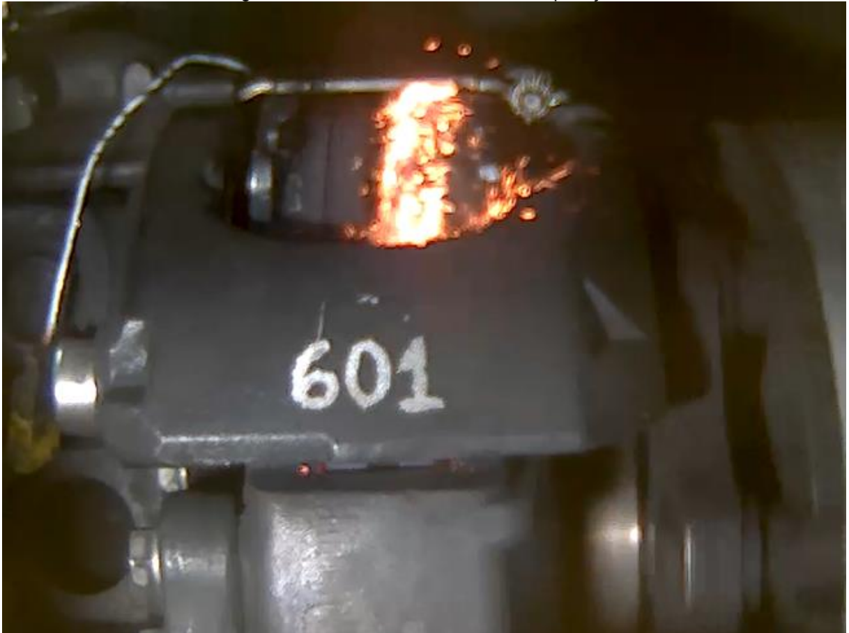
Figura 39 - FMVSS chamas durante a aplicação
