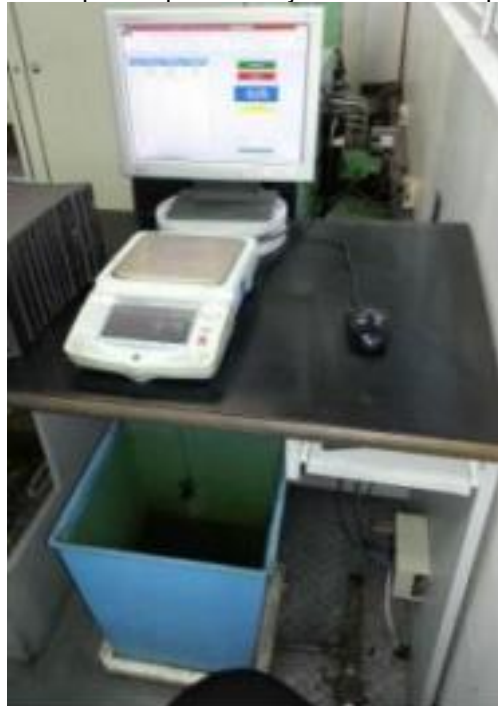
Figura 6 – Aparato para medição da massa específica
