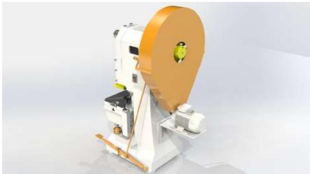
Figura 7: Proteção de volante [12].
