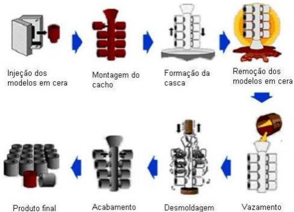
Figura 4 – Processo fundição cera perdida
