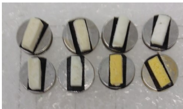
Figura 17: Amostras fixadas nos porta-amostra antes da metalização.
