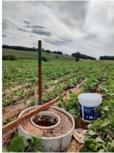
Figura 6 - Avaliação da infiltração de água no solo com o método de infiltrômetro de anel.
