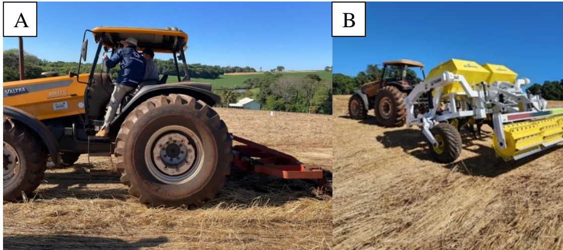
Figura 2 - Manejo de solo com subsolador convencional (A) e manejo de solo com descompactador rotativo com rolo faca Vollverini (B).
