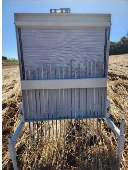
Figura 5 - Avaliação da rugosidade do solo com auxílio do perfilômetro convencional.
