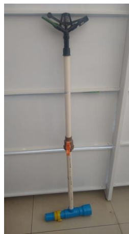
Figura 11. Utilização de aspersor com tubo de subida com registro.
