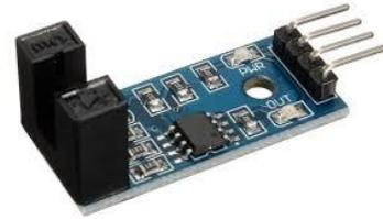
Fig. 11. Sensor de rotação com fototransistor.
