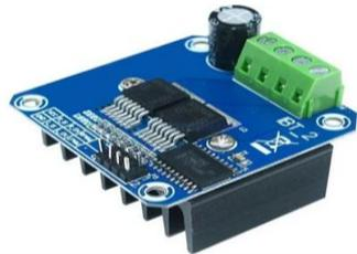
Fig. 10. Ponte H BTS7960 para controle de potência do motor CC.
