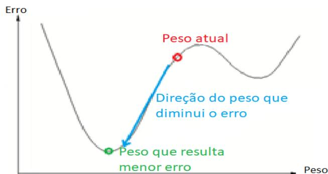
Fig. 15. Gradiente descendente do erro.
