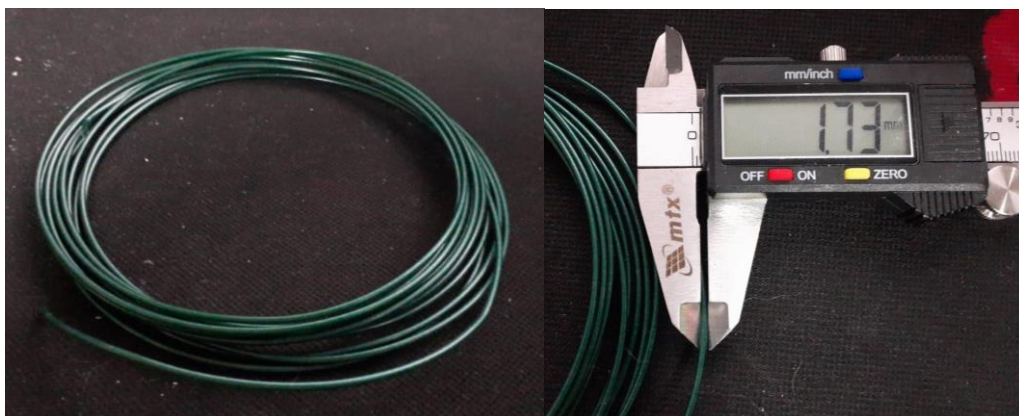
Figura 09 – Demonstração e medição realizada no diâmetro do material disponível no mercado
