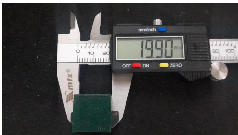
Figura 10 – Medição da peça gerada utilizando o material disponível no mercado.
