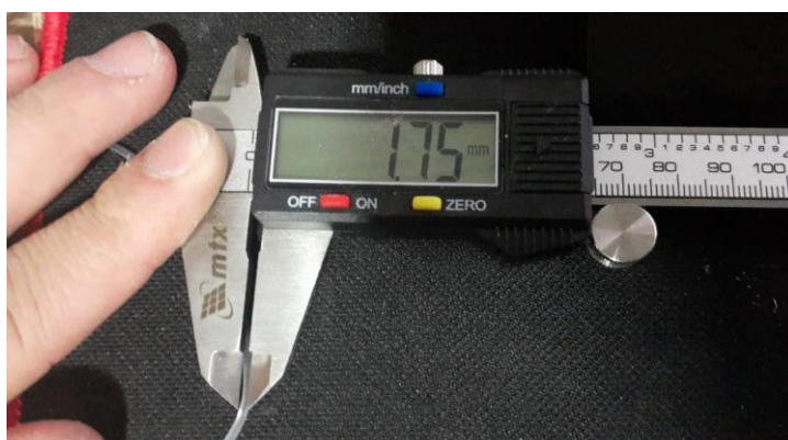
Figura 07 – Filamento gerado pelo artefato final
