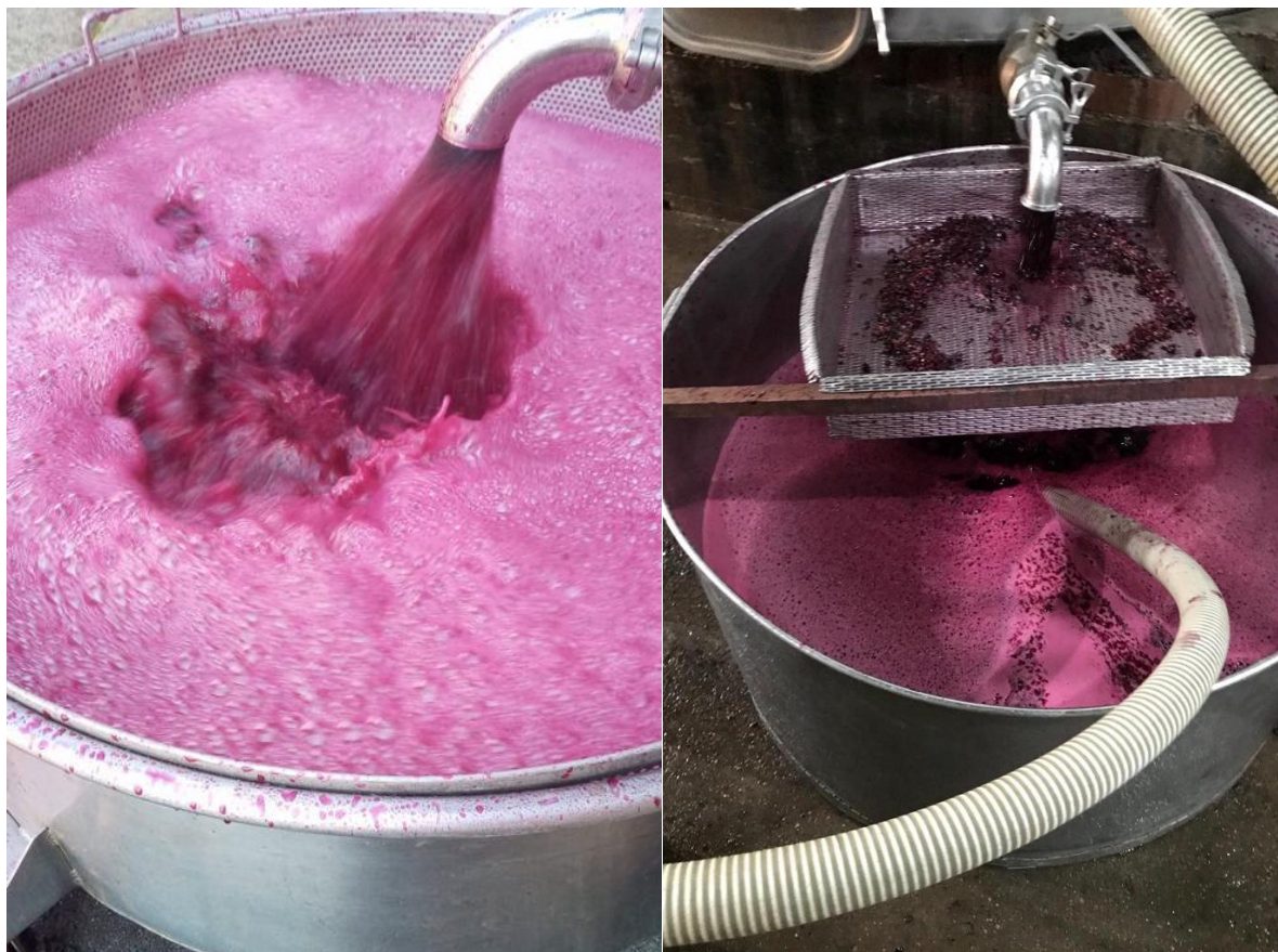
Figura 34: Processo de remontagem em aberto do vinho em etapa de fermentação alcoólica. Fonte: Arquivo vinícola Cave Antiga, safra 2021.
