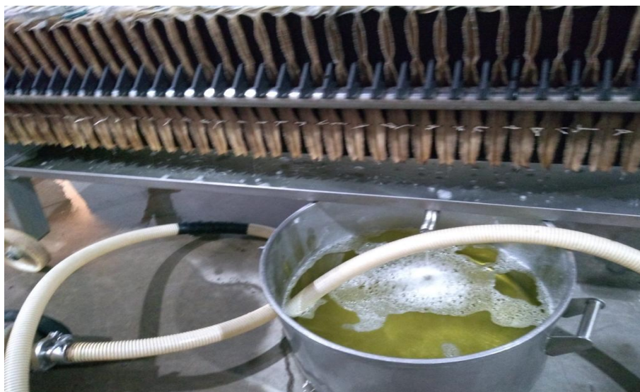
Figura 37: Momento de filtração da uva Schönburger, com auxílio do filtro a placa. Fonte: Arquivo pessoal, safra 2021.
