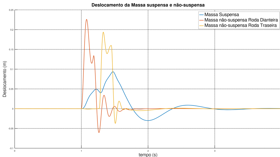
Figura 28 - Comparação da massa suspensa com as massas não-suspensas
