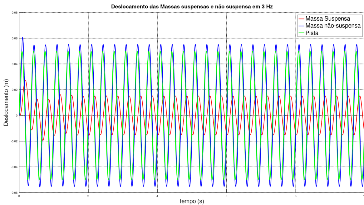
Figura 19 - Deslocamento Massa Suspensa, Massa não-suspensa e perfil da pista
