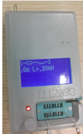
Figura 18 – Testador de componentes com indicação do valor da indutância L.
