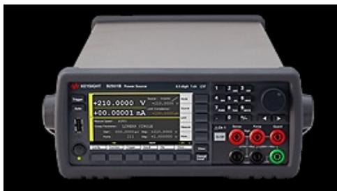
Figura 10 – Analisador de parâmetros Keysight B2901B. Fonte: Adaptada de (TECNOLOGIES, 2020)
