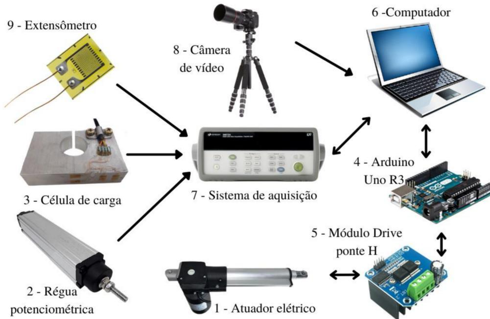
Figura 9 – Sistema de aquisição de dados e controle do atuador (*hardware*).
