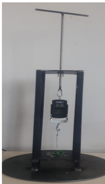
Figura 5. Dispositivo criado para testes mecânicos na fixação de componentes em circuitos elétricos
