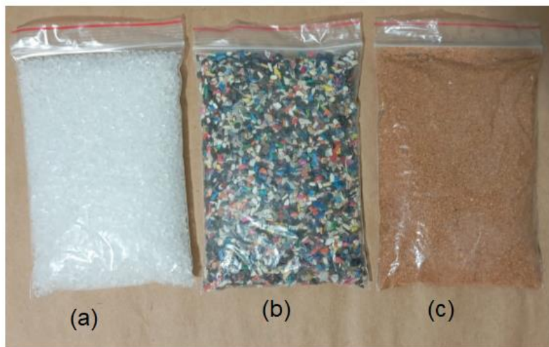
Figura 9 – PP Virgem (a), Plásticos reciclados (b), serragem (c).
