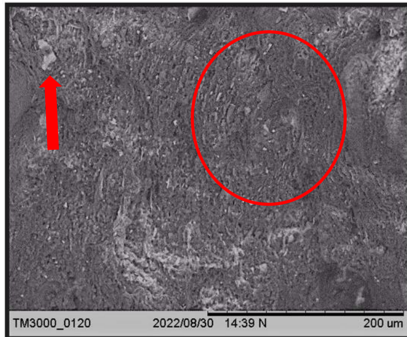
Figura 23 - MEV dos compósitos, RV3 30% de madeira, com aumento de 400x.
