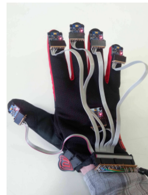
Figura 3. Protótipo de luva sensorizada para captação e transmissão de movimentos [8]
