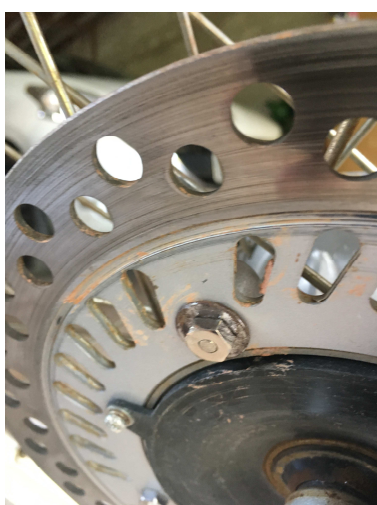
Fig. 23 – Imã inserido num parafuso M6 que suporta o disco de freio dianteiro.
