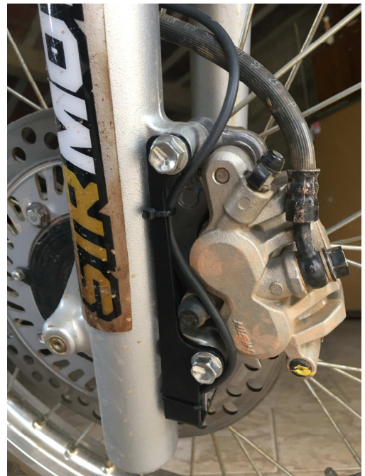
Fig. 21 – Detalhe do suporte do sensor de velocidade.
