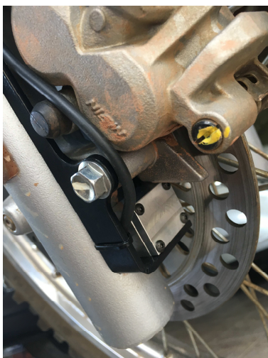
Fig. 22 – Detalhe do invólucro para o sensor de velocidade.
