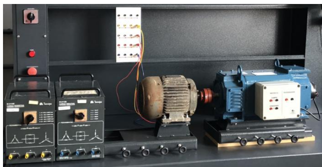
Figura 17: Bancada utilizada para ensaiar o GIAE.
