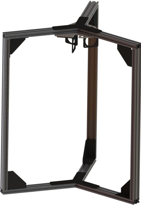
Fig. 11: Projeto da estrutura de sustentação.
