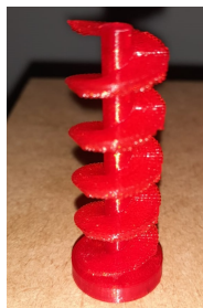
Figura 13 – Resultado da impressão do eixo helicoidal.
