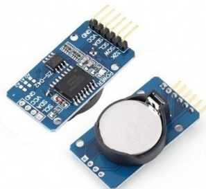
Figura 36 – Módulo RTC DS3231.
