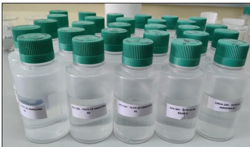
Figura 18 – Frascos contendo as soluções após os ensaios, preparados para análise de absorção atômica
