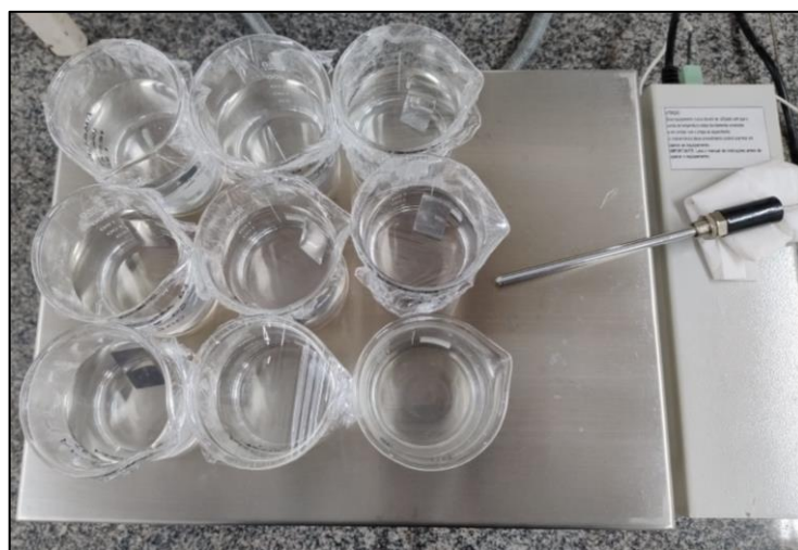
Figura 17 – Recipientes com amostras na chapa aquecedora mantidas a 100°C por duas horas
