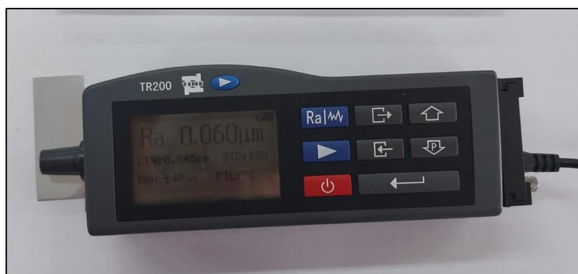
Figura 12 – Medição da Rugosidade média ( R_a ) de uma amostra de aço AISI 304 utilizada no experimento
