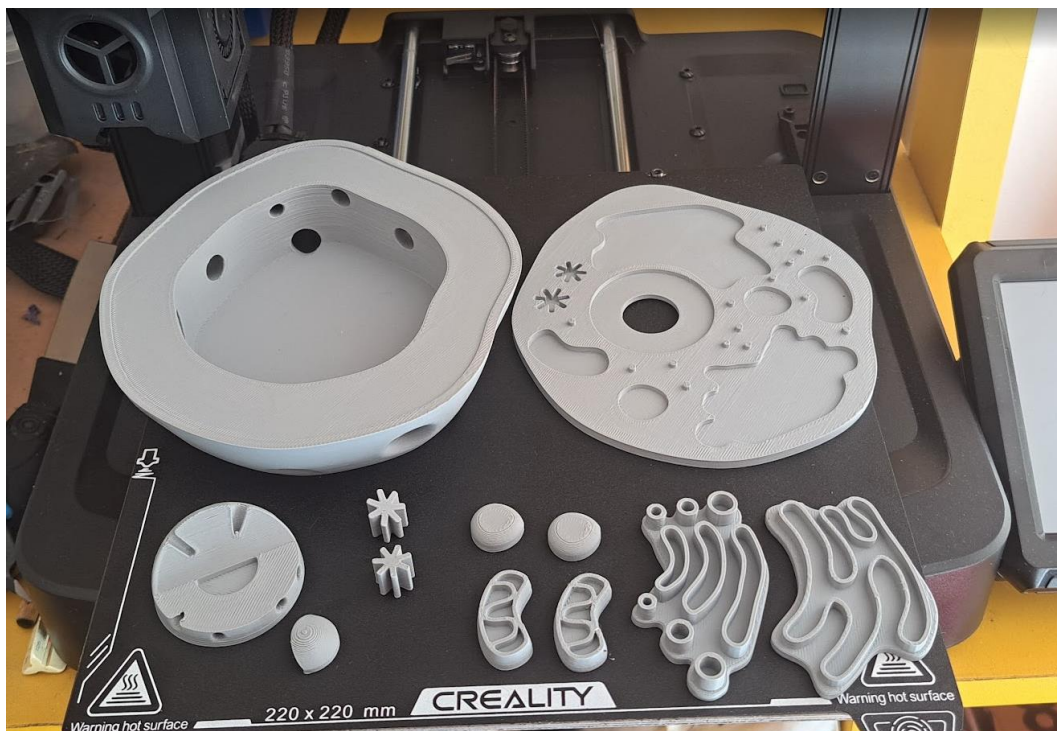
Figura 14 - Representação de doze partes que formam a célula animal produzidos com impressão 3D
