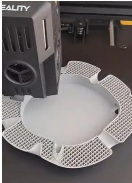
Figura 13 - Representação da membrana celular produzidos com impressão 3D
