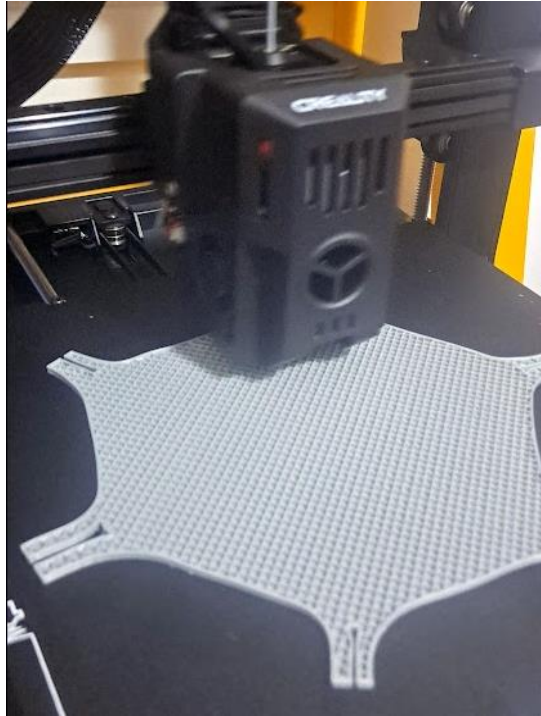
Figura 8 - Representação da parede celular no momento da impressão 3D
