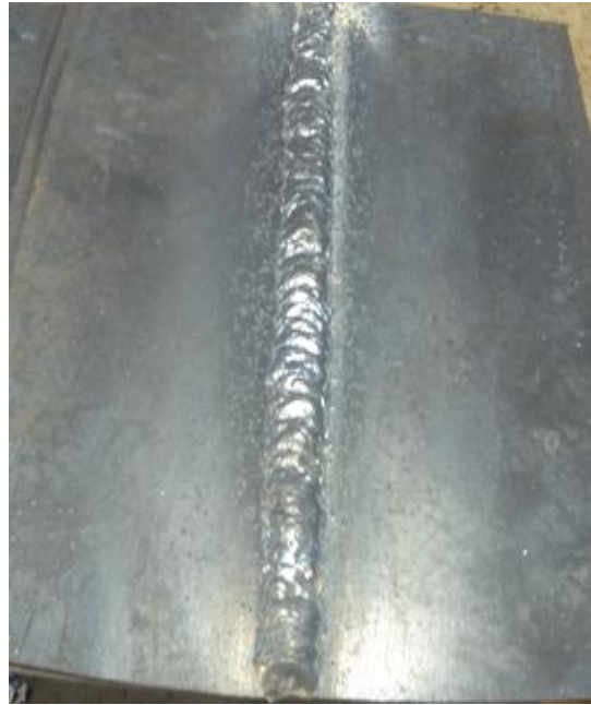
Figura 12. Pós limpeza FCAW-S.
