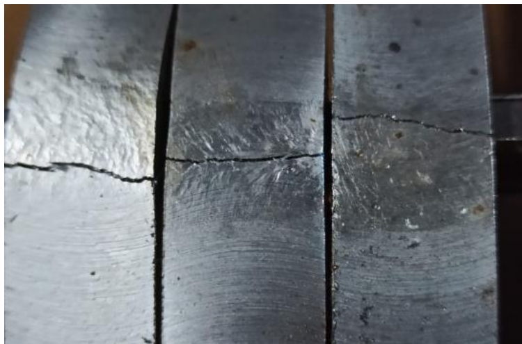
Figura 19. Análise da face de dobra para FCAW-S.
