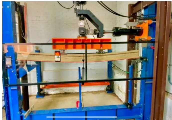
Figura 12. Ensaio de flexão em viga biapoiada.
