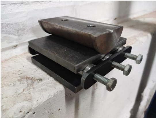
Figura 11. Fixadores do corpo de prova montados.
