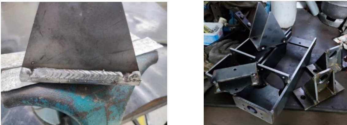
Figura 9. Partes unidas por pontos de solda e soldadas em definitivo.
