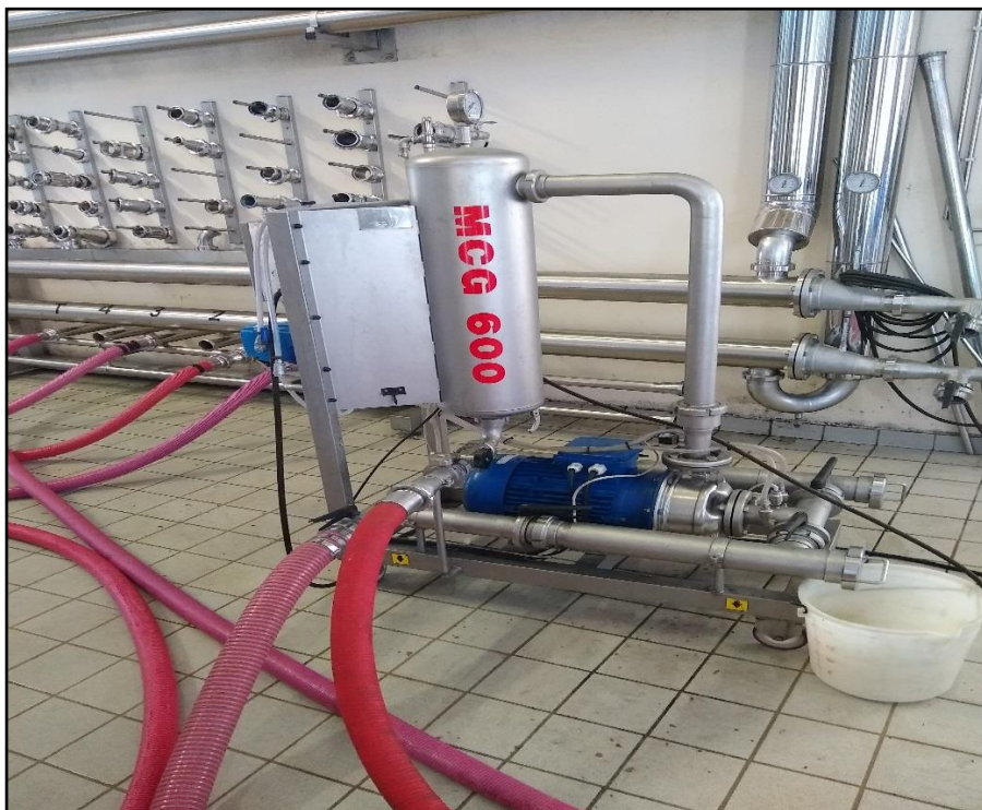
Figura 10: Flotador utilizado para limpeza de mosto. Fonte: Diego Piccoli (Ce. Vi. V Cobertaldo IT 2018).
