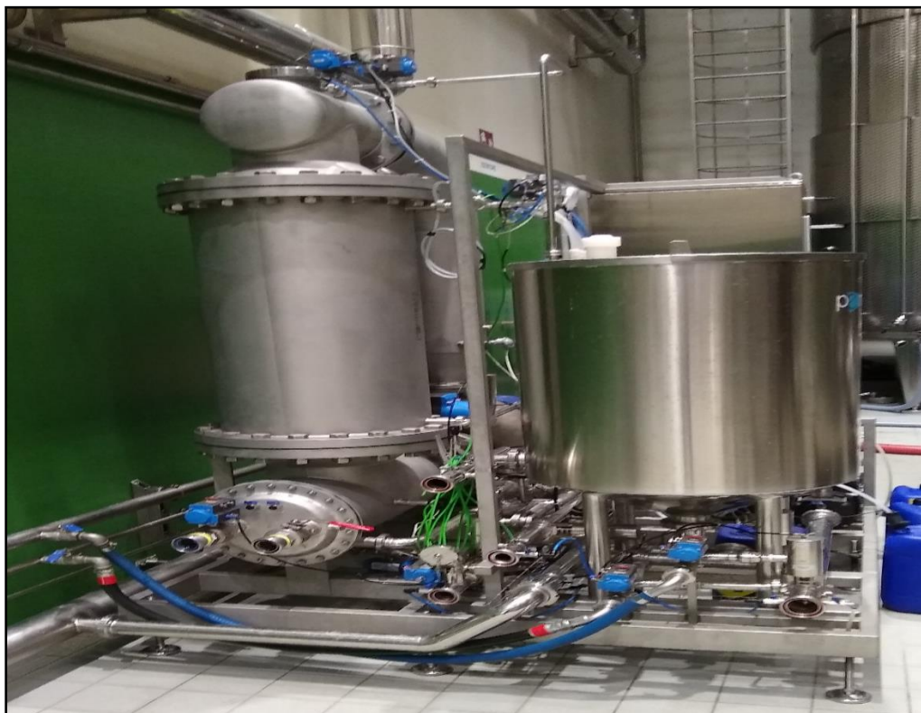
Figura 14: Filtro a placa utilizado para filtrar resíduos de estabilização proteica. Fonte: Diego Piccoli (Ce.Vi.V Sussegana IT 2018).
