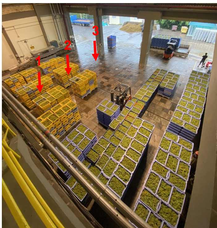
Figura 5. Recebimento de uvas, 1º Piso. Três pontos com tubulações no piso para encher as prensas.
