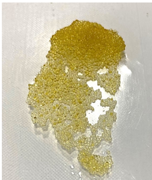
Figura 4. Resina de troca catiônica, microesferas de aproximadamente 0,6mm.
