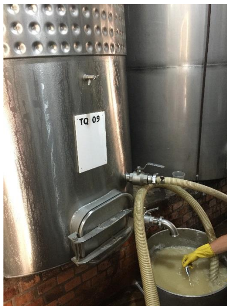
Figura 6 Adição das leveduras via remontagem
