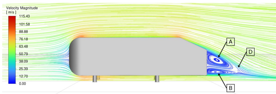
Figura 32 – Características do fluxo de ar do Corpo de Ahmed (simulação)
