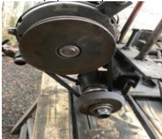
Figura 21 – Conjunto da afiação por esmeril que receberá uma proteção móvel.
