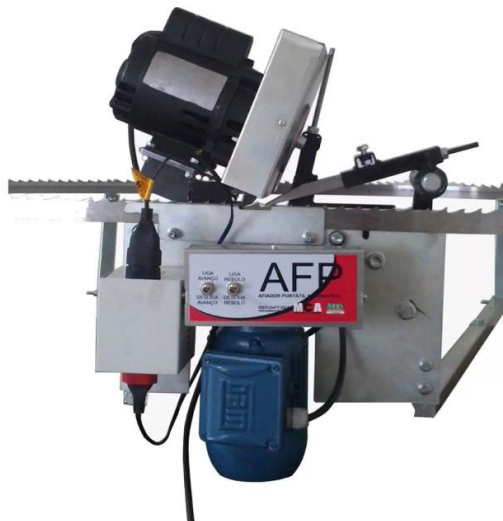
Figura 8 – Exemplo de máquina de afiar lâmina de serra fita disponível no mercado
