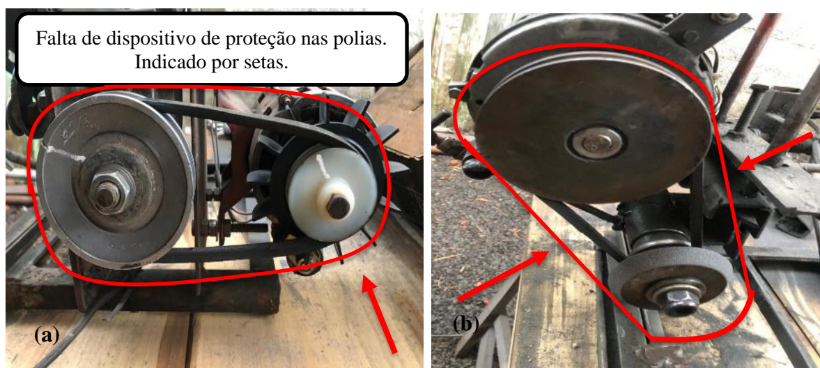
Figura 15 – As polias do empurrador (a) e o esmeril (b) não possuem proteção física
