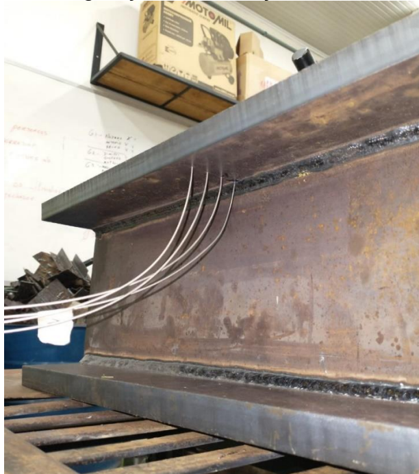
Figura 25 – Configuração de instalação dos sensores na viga.
