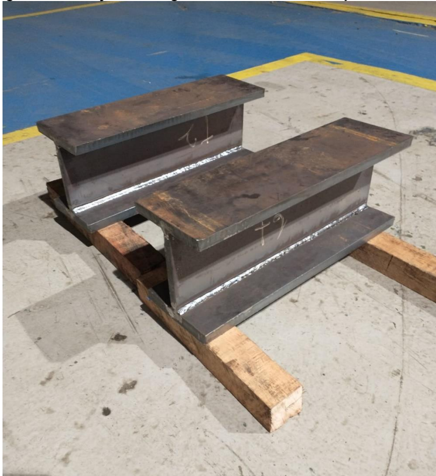
Figura 23 – Seções de viga “I” adotadas como objeto de estudo.
