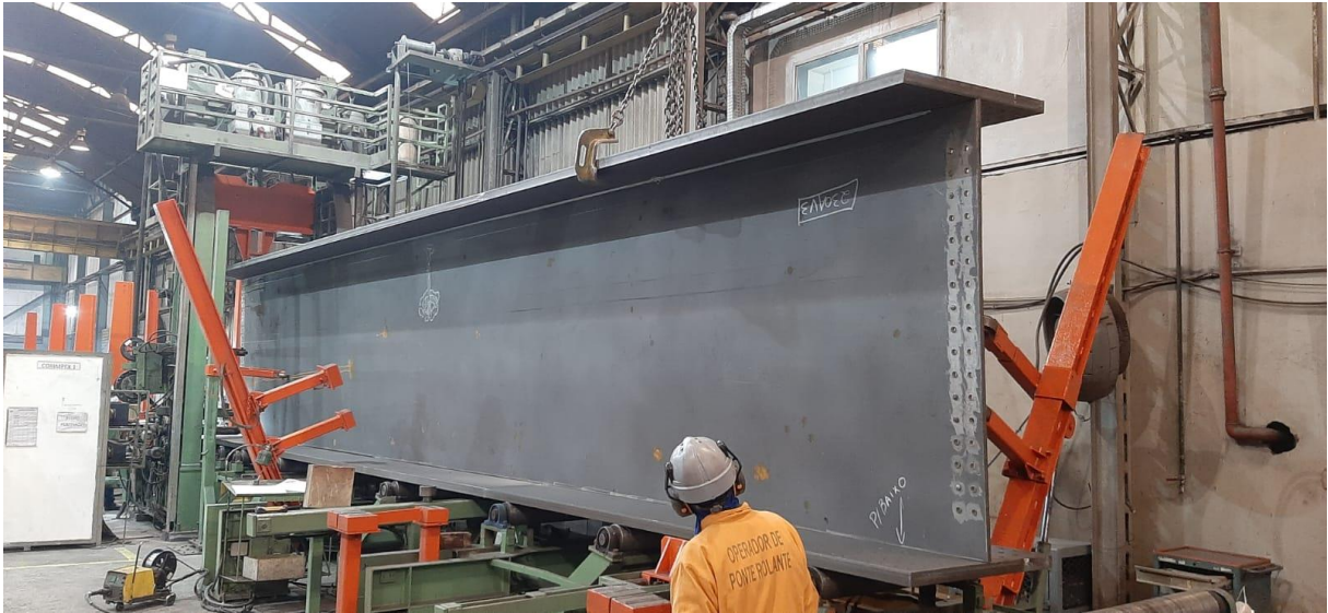
Figura 9 – Composição de um perfil I em aço patinável por meio de solda a arco submerso.
