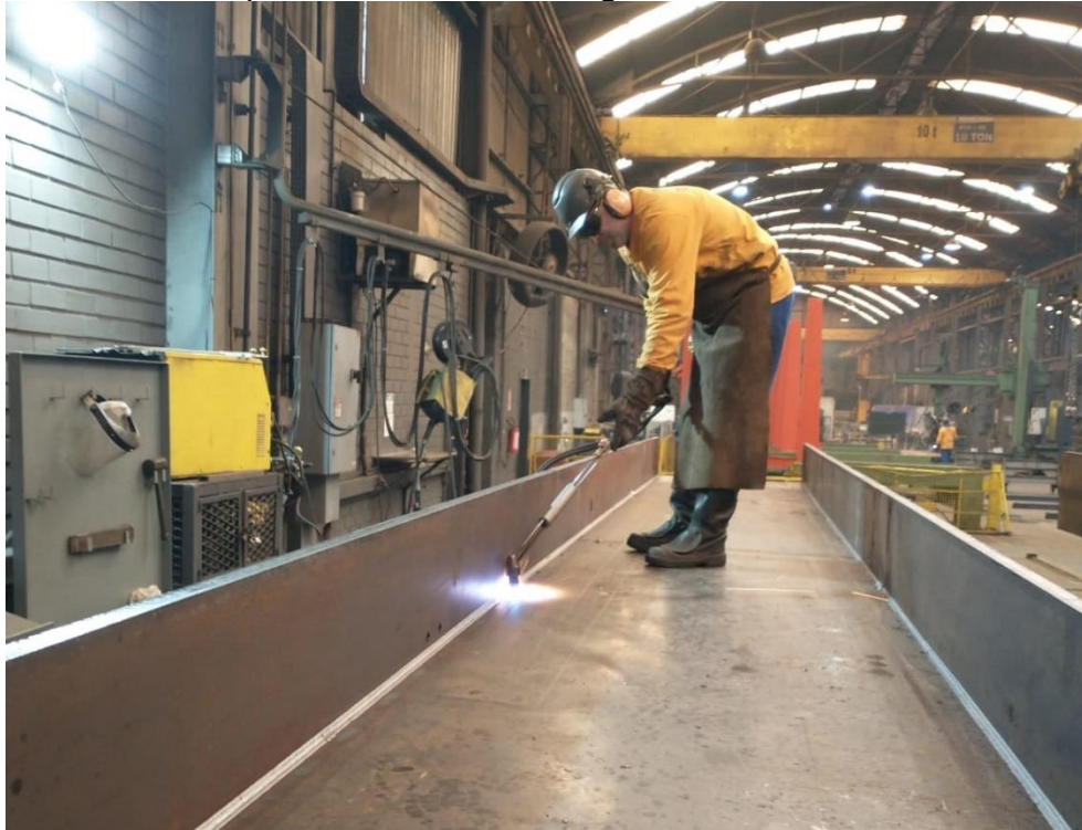
Figura 21 – Desempeno manual por chama para correção de distorção de paralelismo em uma viga “I” estrutural.
