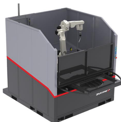
Figura 7 - Célula de soldagem com 6 graus de liberdade
