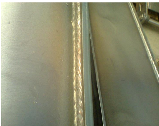
Figura 12 - Cordão de solda oriundo do processo automático
