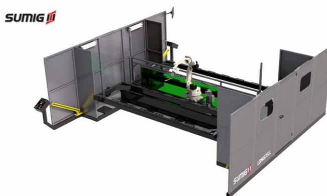
Figura 8 - Célula de soldagem com 7 graus de liberdade
