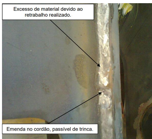
Figura 13 - Cordão de solda oriundo do processo manual
