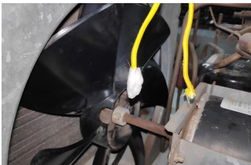
Figura 28 – Termopares instalados para a medição da TBS e TBU do ar ambiente
