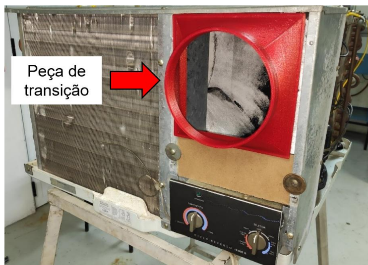
Figura 20 – Peça de transição acoplada na saída do trocador de calor interno
