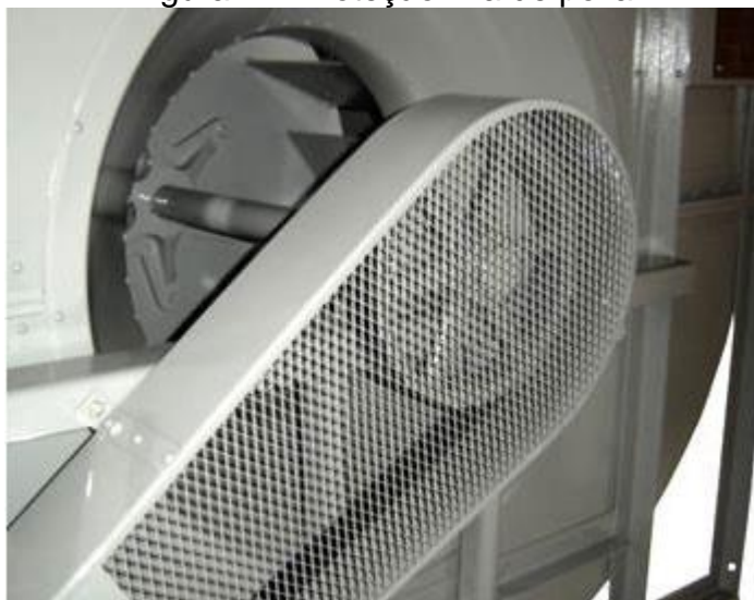
Figura 4 – Proteção fixa de polia.
