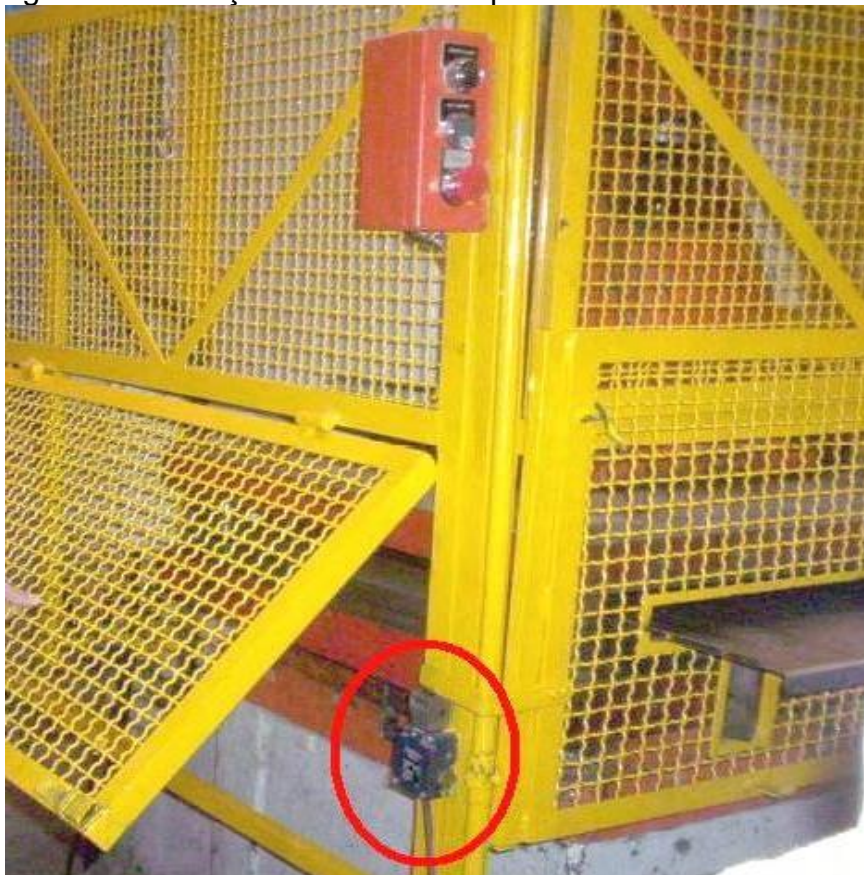
Figura 5 – Proteção móvel com dispositivo de intertravamento.
