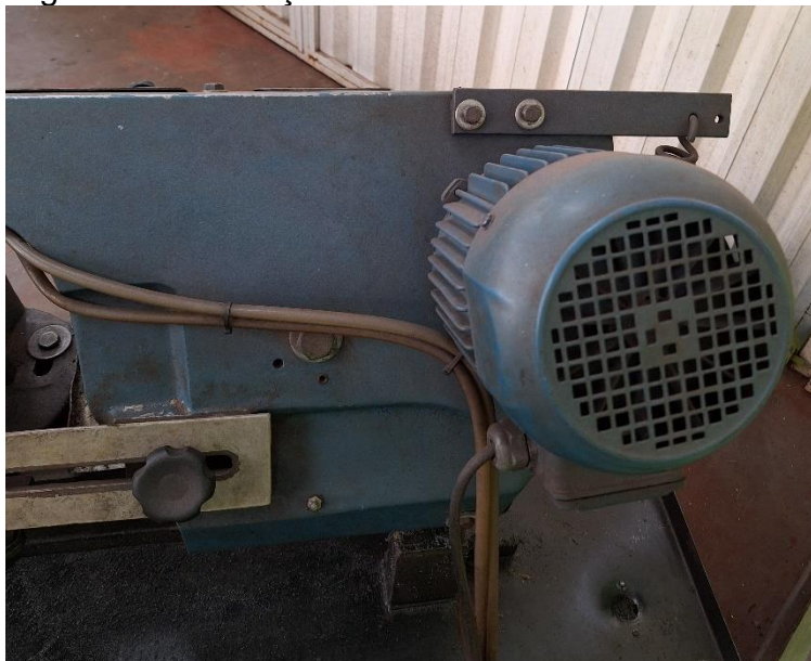
Figura 17 – Proteção em elementos de transmissão.
