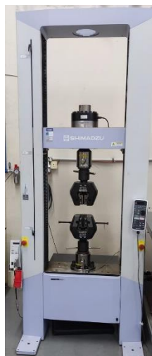
Figura 15 – Máquina universal de ensaios SHIMADZU.
