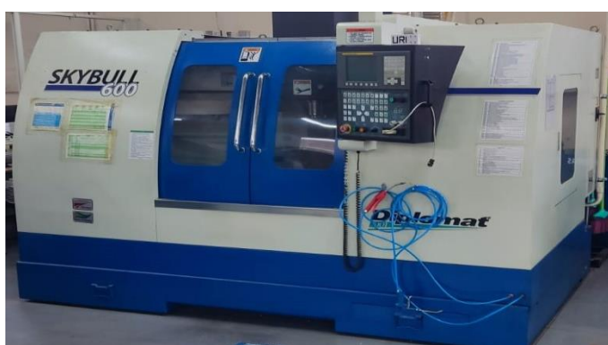
Figura 8 – Centro de Usinagem CNC de três eixos, SKYBULL 600.
