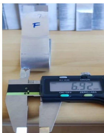
Figura 28 – Corpo de prova 7, com a medição do tamanho da trinca.
