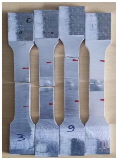
Figura 26 - Corpos de prova, após a realização do ensaio de tração do Experimento ombro Liso.
