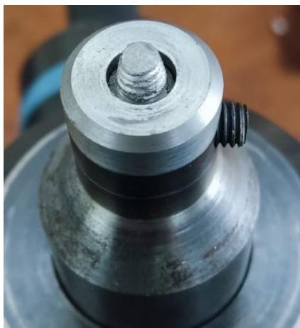
Figura 19 – Ferramenta com ombro liso.
