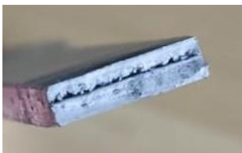
Figura 29 – Cp 06, corpo de prova apresentando vazios internos.
