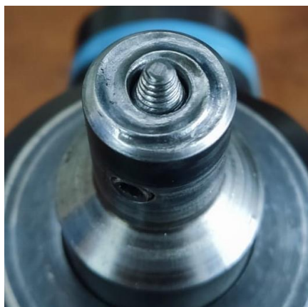
Figura 18 – Ferramenta para soldagem, ombro espiral (Experimento Espiral).
