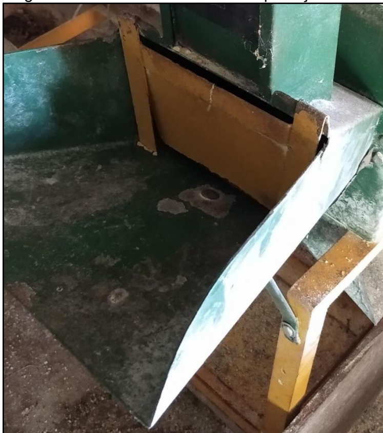
Figura 17 – Calha de entrada com proteção móvel.
