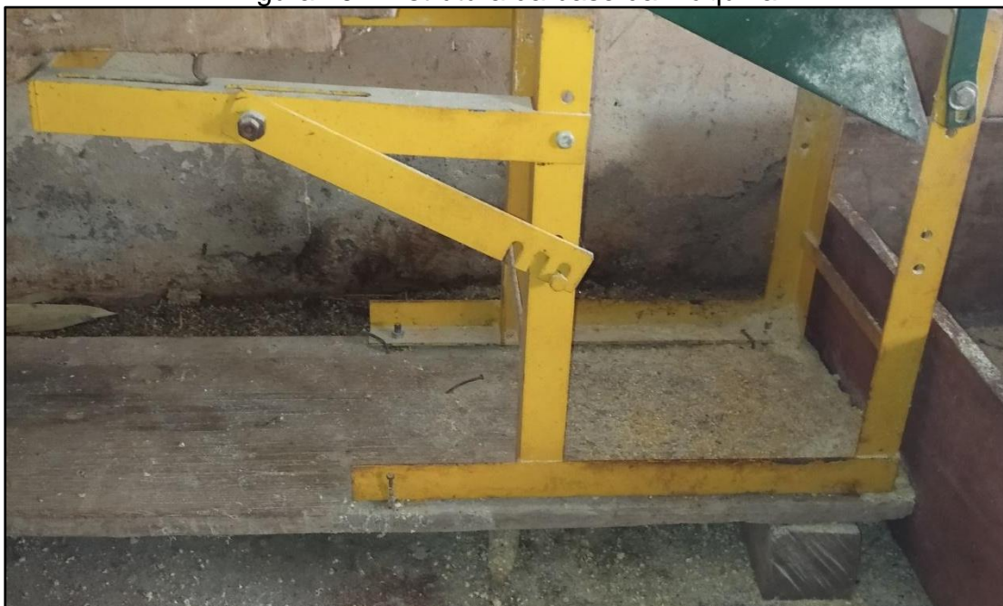
Figura 20 – Estrutura da base da máquina.
