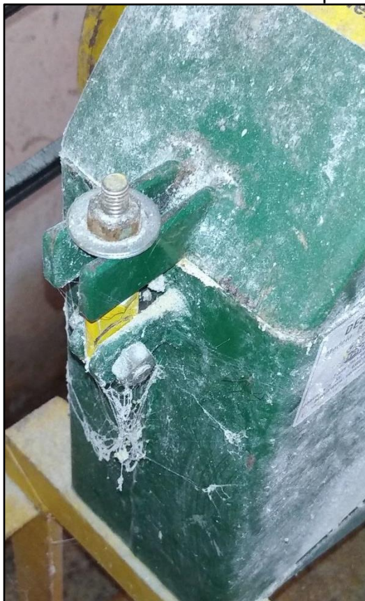
Figura 19 – Sistema de travamento da tampa da máquina.
