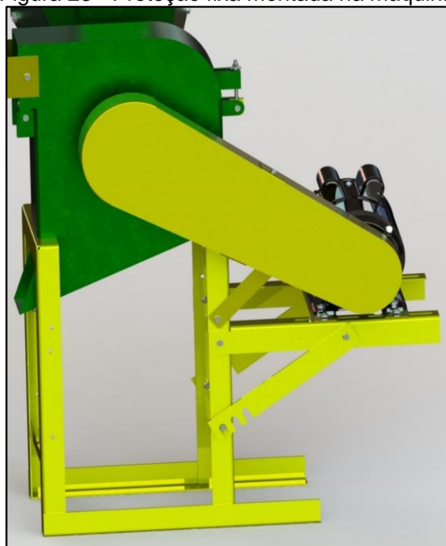
Figura 23 - Proteção fixa montada na máquina.
