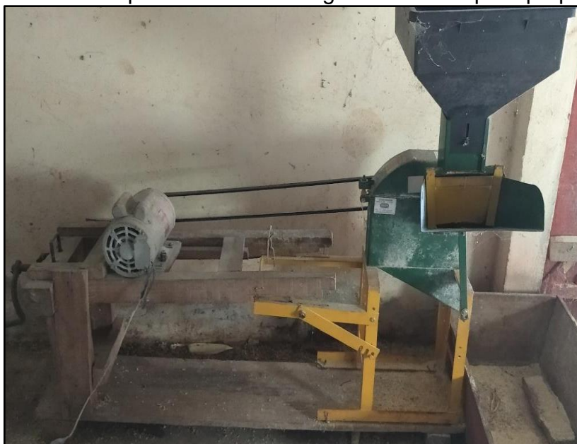
Figura 14 – Máquina trituradora de grãos utilizada para proposta.
