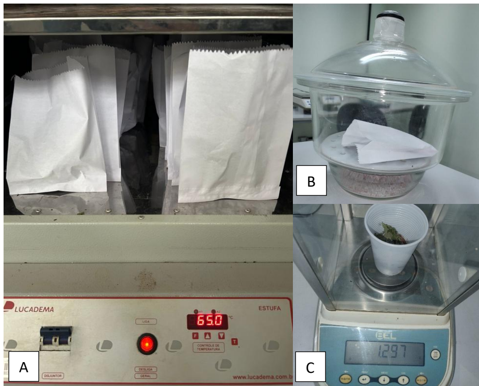
Figura 8 - Plântulas envelopadas na estufa (A). Plântula em câmara com sal (B). Plântula sendo pesada em balança de precisão (C).
