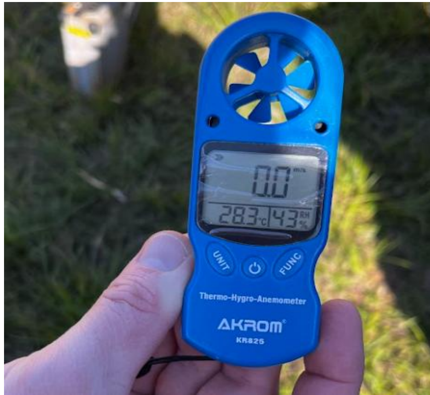
Figura 9- Termo-higro-anemômetro digital da marca AKROM utilizado para aferir as condições climáticas para a realização dos voos
