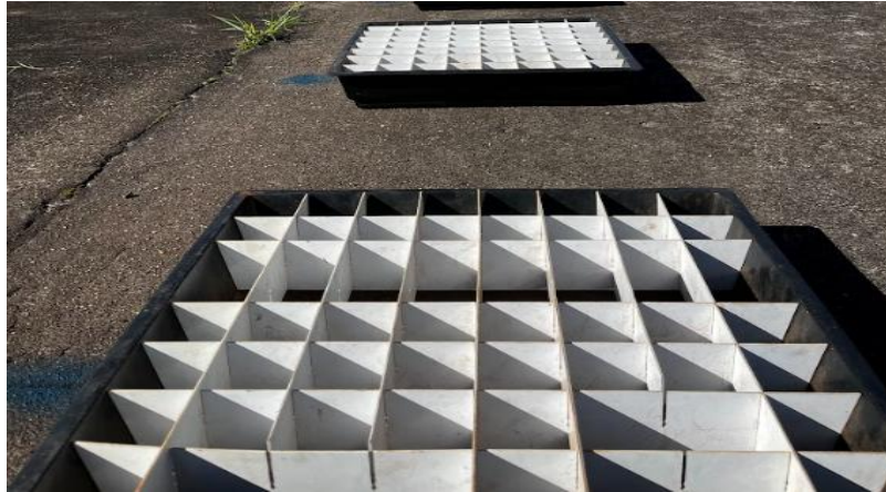
Figura 4- Grades internas para minimizar o repique das partículas nas bandejas
