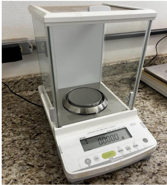
Figura 11- Balança analítica de 3 casas após a vírgula utilizada nas pesagens das amostras coletadas
