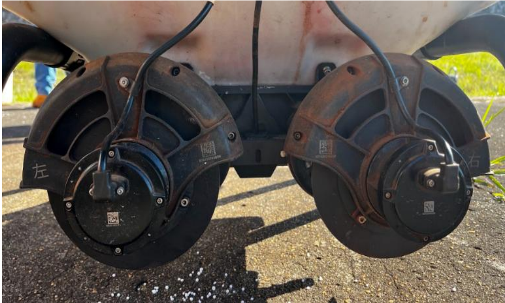
Figura 6- Novo sistema de distribuição de insumos sólidos com roscas alimentadoras Revo Cast 2
