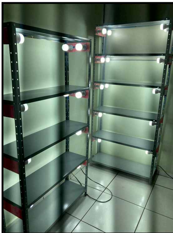
Figura 3 - Estantes de metal com sistema de iluminação e fotoperíodo para a sala de crescimento do Laboratório de Biotecnologia e Propagação Vegetal
