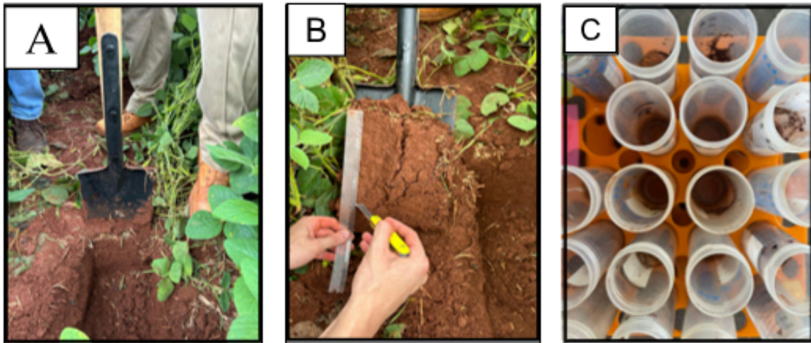
Figura 13 – Coleta e análise de solo: Abertura da trincheira (A); Corte e coleta da amostra (B); Análise no laboratório (C). Ibirubá/RS 2024
