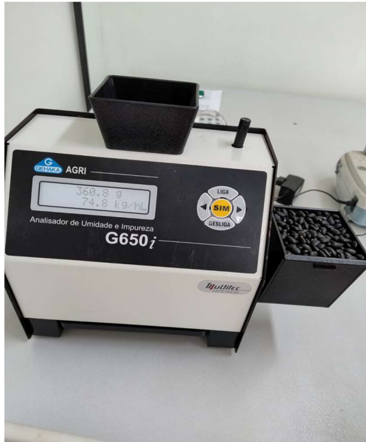
Figura 3 - Aparelho Gehaka, utilizado para determinação do peso hectolitro.
