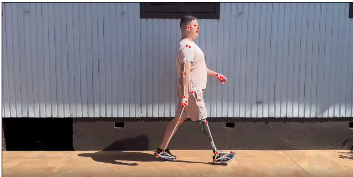
Figura 6. Exemplo de frame capturado do vídeo, com os pontos anatômicos.
