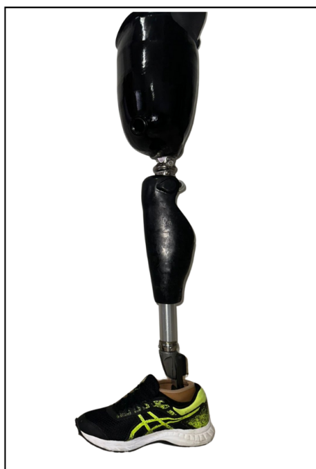
Figura 3. Prótese endoesquelética com joelho C-LEG 4 Fonte: Elaborado pelos autores.
