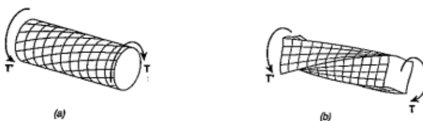
Figura 15 - Torção em eixos: a) eixo redondo; b) eixo quadrado
