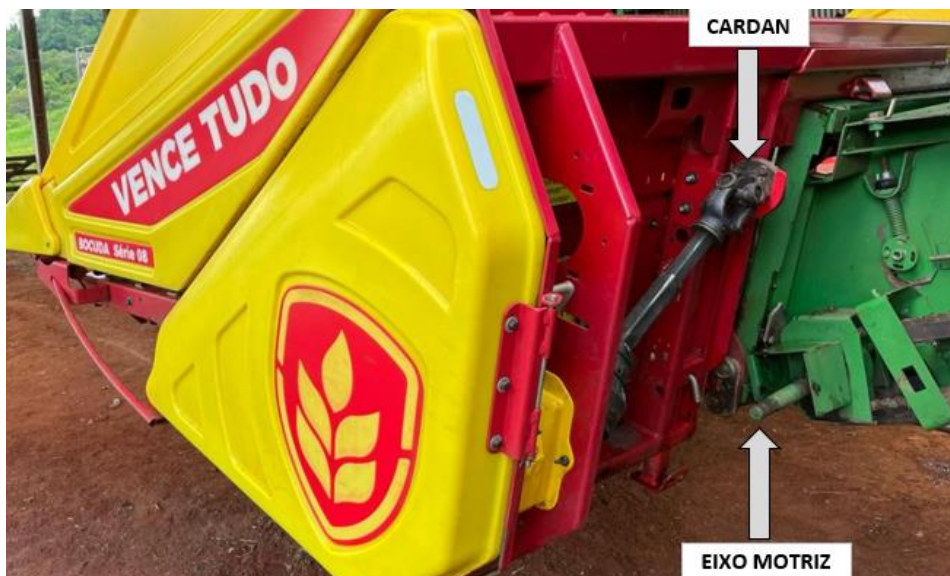
Figura 12 – Eixo motriz da colhedora e eixo cardan da plataforma
