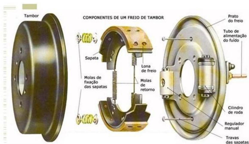
Figura 5-Vista explodida do tambor de freio.
