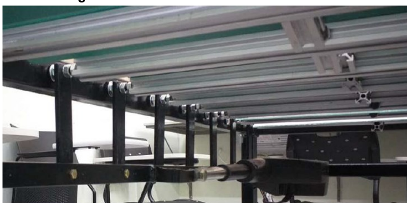
Figura 12: Sistema de 4 barras e atuador linear
