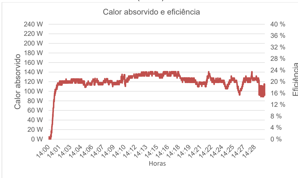
Gráfico 15: Calor absorvido e eficiência em circuito aberto, ao longo do tempo, no dia 25/04/2025 (Teste 1).
