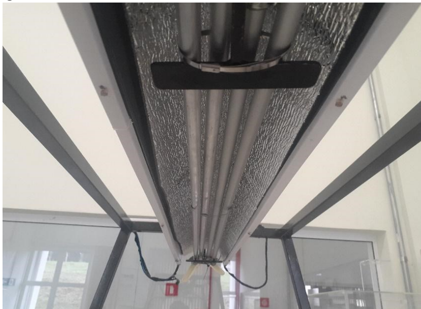
Figura 13: Absorvedor com os tubos de transferência de calor montados.
