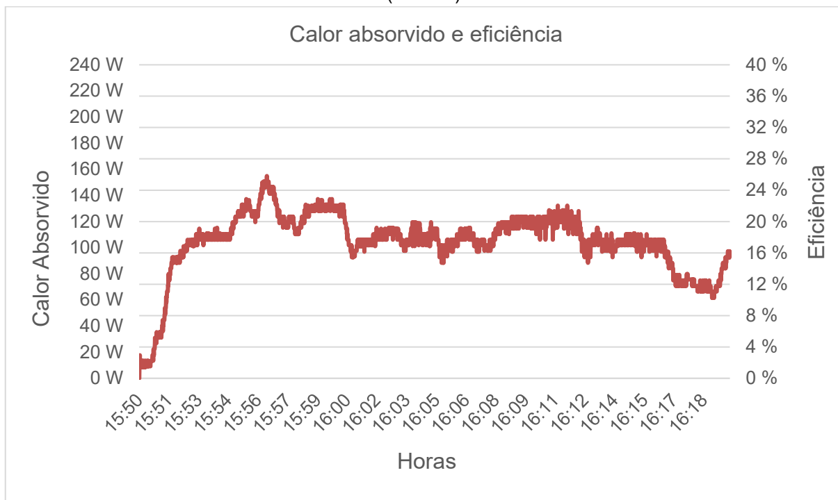
Gráfico 14 : Calor absorvido e eficiência em circuito fechado, ao longo do tempo, no dia 20/03/2025 (Teste 2).
