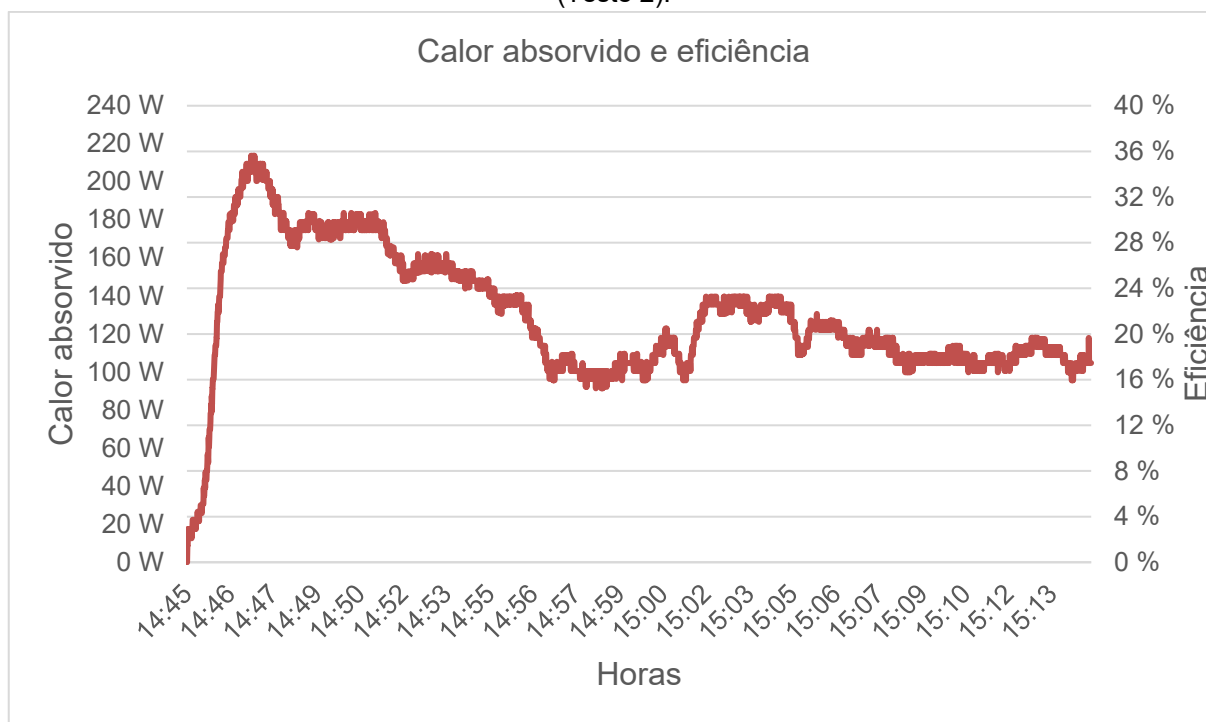
Gráfico 16: Calor absorvido e eficiência em circuito fechado, ao longo do tempo, no dia 15/05/2025 (Teste 2).
