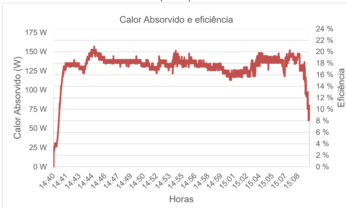
Gráfico 13: Calor absorvido e eficiência em circuito fechado, ao longo do tempo, no dia 20/03/2025 (Teste 1).
