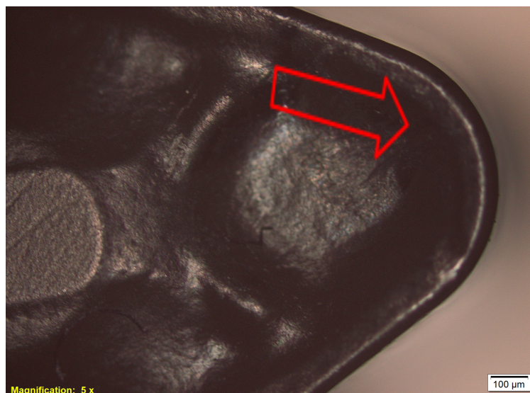
Figura 30 - Macrografia de inserto novo.
