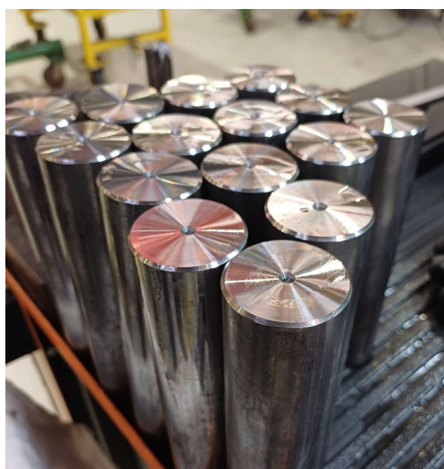
Figura 21 - Tarugo após faceamento e execução do furo de centro
