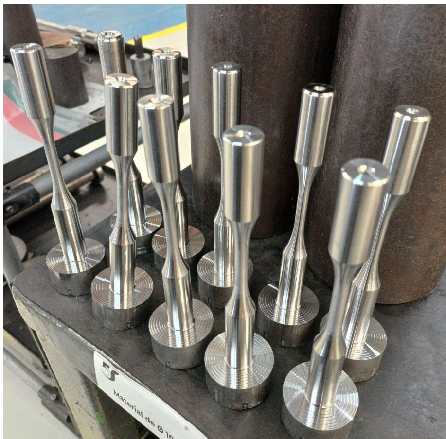
Figura 22 - Tarugo após usinagem do perfil
