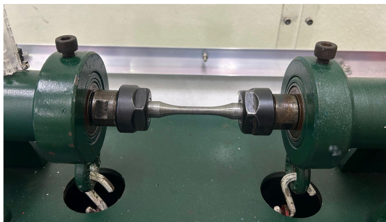
Figura 26 - Corpo de prova preso no sistema de fixação da máquina
