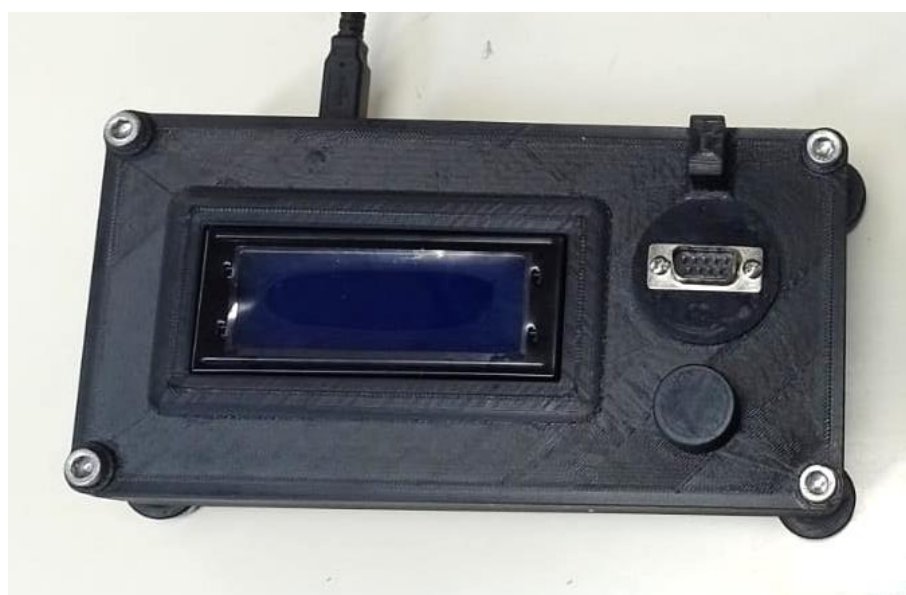
Figura 12 – Caixa confeccionada por impressão 3D.
