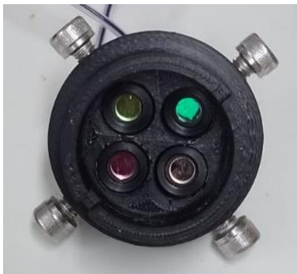
Figura 15 – Suporte com os filtros de radiação e os fototransistores.
