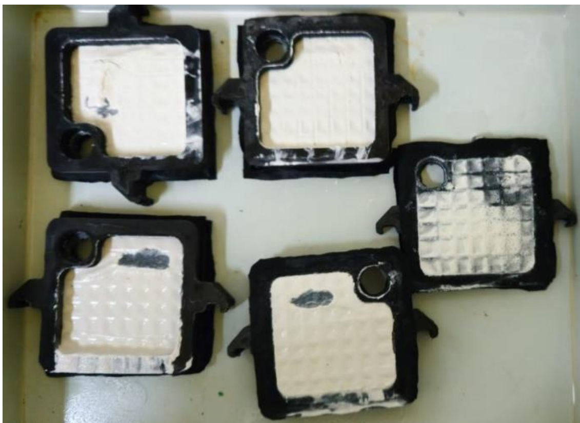
Figura 28 – Torta formada nos testes a 0,10 bar
