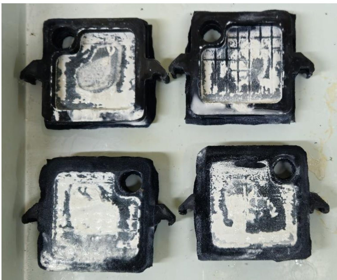
Figura 24 – Torta formada nos testes a 0,04 bar
