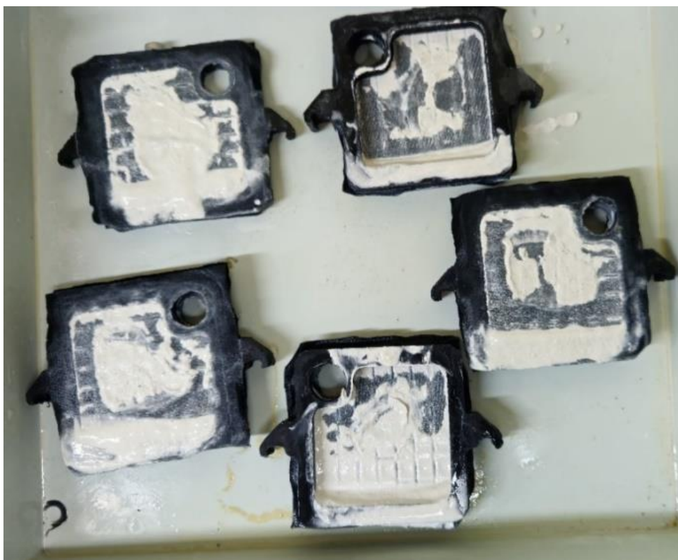
Figura 22 – Torta formada nos testes a 0,02 bar
