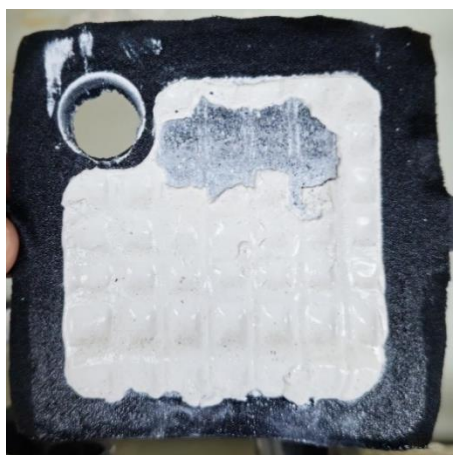
Figura 20 – Tecido 100% poliéster com a torta formada
