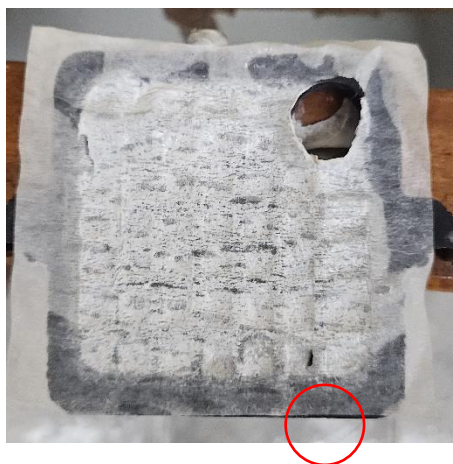
Figura 18 – Filtro de papel rompido após teste
