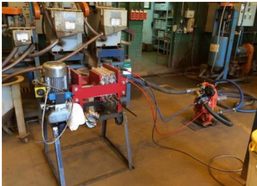
Figura 8 – Protótipo de filtro prensa desenvolvido por Gomes e Batista.
